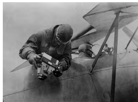
Abb. 3: Die erste Luftbildkammer C2 wird 1927 an die Eidgenössische Landestopographie geliefert.
