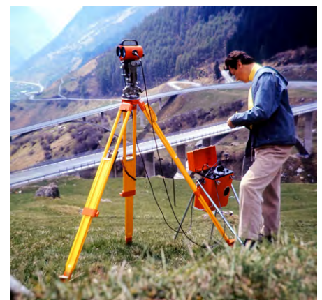
Abb. 9: Der DI10 im Einsatz an der Südfahrt zum damals neuen San-Bernardino-Tunnel.
