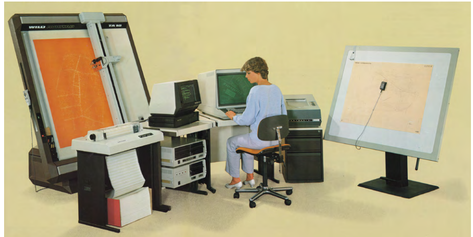
Abb. 13: Das GEOMAP-System. Der linke Bildschirm dient der alphanumerischen Ein- und Ausgabe (mit drei Diskettenlaufwerken darunter für Programme und Daten) und der rechte Schirm der Darstellung der Graphik. Rechts davon ein Gerät für den Druck von Bildschirmhalten und der Digitalisierungstisch.
