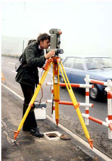
Abb. 12: Der Wild TC1 ist ein vollautomatischer Tachymeter mit Kompaktkassettengerät als digitalen Datenspeicher.
